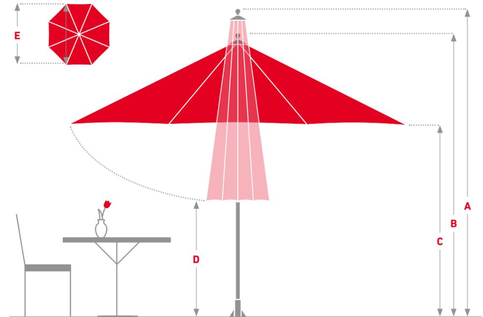
\* Alle Maße beziehen sich auf die Verwendung mit stationärer Verankerung (Bodenhülse). \*\* Bei Verwendung eines Volants verringern sich die Maße um 30 cm.
