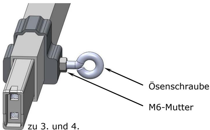
6. Bespannungshaken an Teleskoprohr wieder einhängen und Abschlussdeckel aufdrücken. Beachten Sie dass der Deckel nur in einer Position passt und gegebenenfalls gedreht werden muss.
