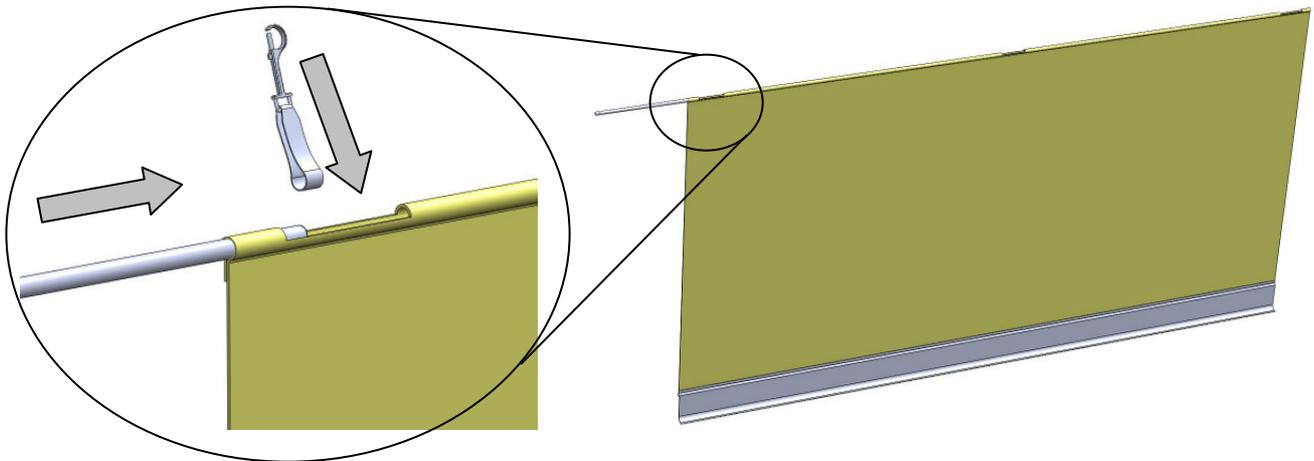
3. Hängen Sie alle Karabinergurte an den Ösenschrauben der Seitenbehang-Befestigungen ein.
