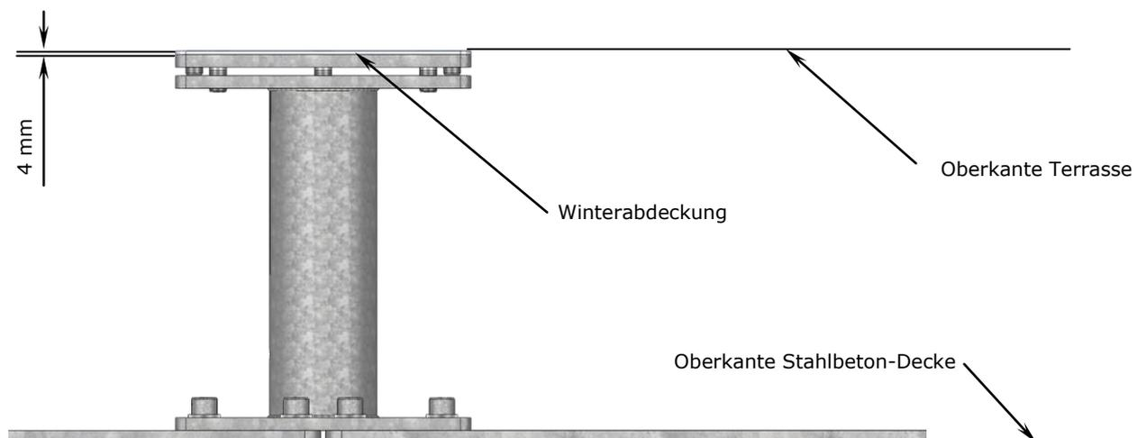
6. Im Normalfall ist die Stahlbeton-Decke nicht horizontal, folglich würde der Schirm später nicht vertikal stehen. Daher müssen Sie das Ankerhülsen-Oberteil mithilfe der drei Stellschrauben ausrichten.
