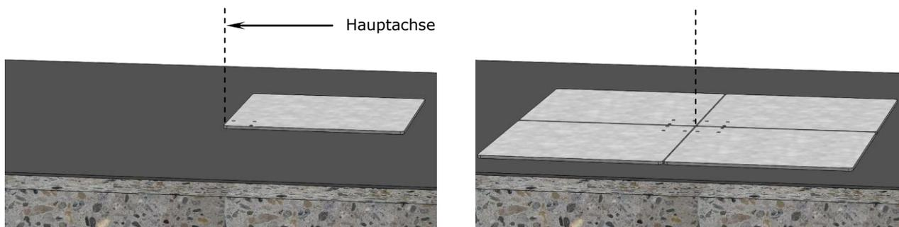
2. Positionieren Sie die SZ240 durch genaues ausmessen der Schirmachse. Halten Sie einen Sicherheitsabstand zwischen den Schirmen / Hauswand.
