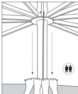
**Rimessa in funzione dopo la chiusura di emergenza:** ad azionamento a motore disaccoppiato, attivare la funzione «Chiudi ombrellone» e attendere fino a che il motore non si spegne da solo nella posizione finale. Chiudere completamente l'ombrellone a mano. Inserire una chiave a dente esagonale da 6 mm nell'apertura al palo e ruotare di circa mezzo giro in senso antiorario. Togliere la chiave a dente esagonale. Controllare il funzionamento attivando la funzione «Apri ombrellone».
