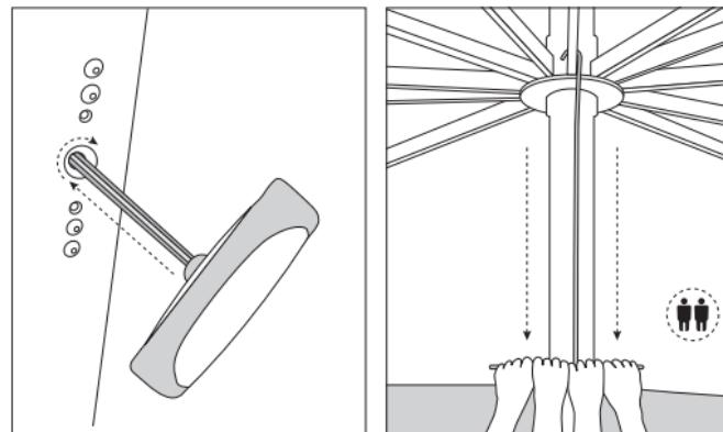
**Wiederinbetriebnahme nach Notschliessung:** bei entkoppeltem Motorantrieb «Schirm schliessen» (AB-Taste) betätigen und warten bis der Motor in der Endlage selbstständig abschaltet. Schirm per Hand komplett schliessen. 6-Kant Stiftschlüssel 6mm in die Öffnung am Mast einführen und ca. eine halbe Umdrehung gegen den Uhrzeigersinn drehen. 6-kant Stiftschlüssel abziehen. Durch Betätigung «Schirm öffnen» (AUF-Taste) Funktionskontrolle durchführen.
