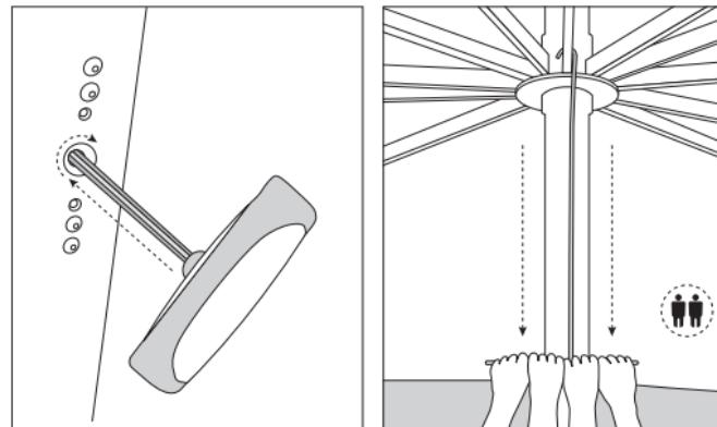
**Reprise de l'entraînement après une fermeture d'urgence:** lorsque l'entraînement motorisé est découpé, appuyer sur «fermeture du parasol» et attendre que le moteur s'éteigne de façon autonome en position finale. Fermer complètement le parasol manuellement. Insérer la clé fileté à 6 arêtes de 6 mm dans l'ouverture du mât et la tourner environ un demi-tour dans le sens contraire des aiguilles d'une montre. Oter la clé à 6 arêtes. Contrôler le fonctionnement en actionnant «ouverture du parasol».
