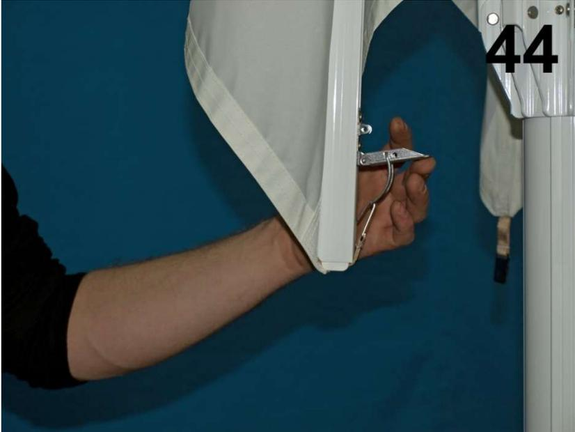
Klinken Sie den Membranhaken in den Federbügel des Exzenterverschlusses ein und legen Sie anschließend den Verschlusshebel nach oben um.
