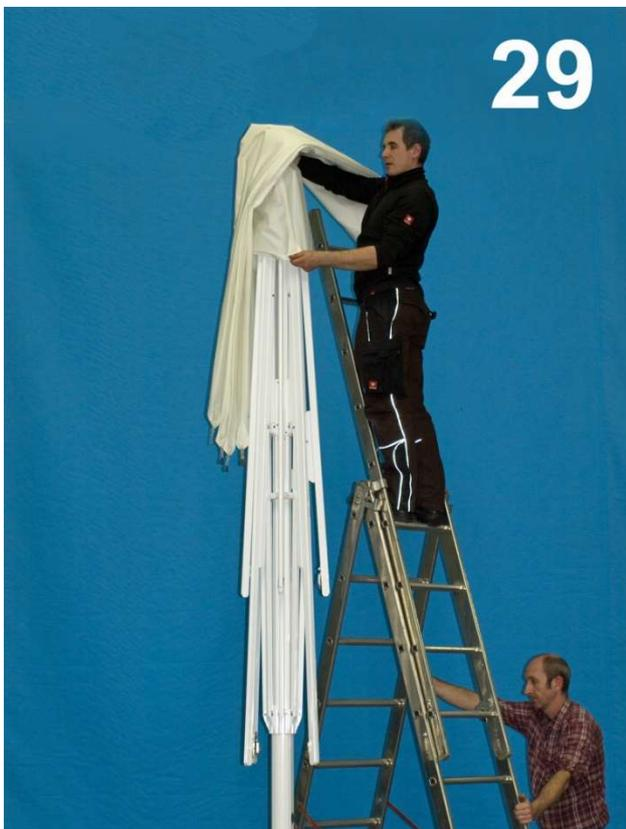
**...Dachkanten der Membrane zu fassen bekommen, um sie über die Gestellspitze hinwegzuheben und so mit dem Überstülpen der Membrane über das faltgestell zu beginnen.**
