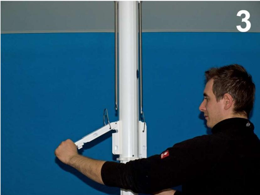
**Zuerst den linken Spannhebel öffnen und den Federbügel aus der Raste der Zugstange ausklinken.**
